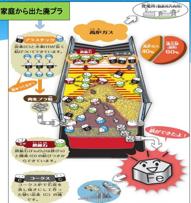
市町村からリサイクル工場に 運び込まれた廃プラスチック (ベール)は、鉄分、塩化ビニ ル等を取り除き、細かく砕いた 後、押し固めて容積を少なくし て「再生プラ粒」にします。
