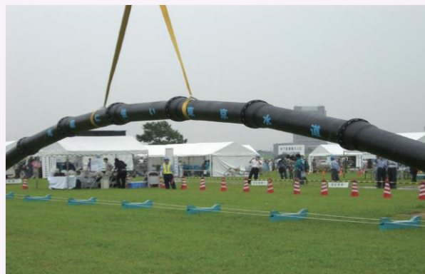
耐震継手管の吊り上げ実験
