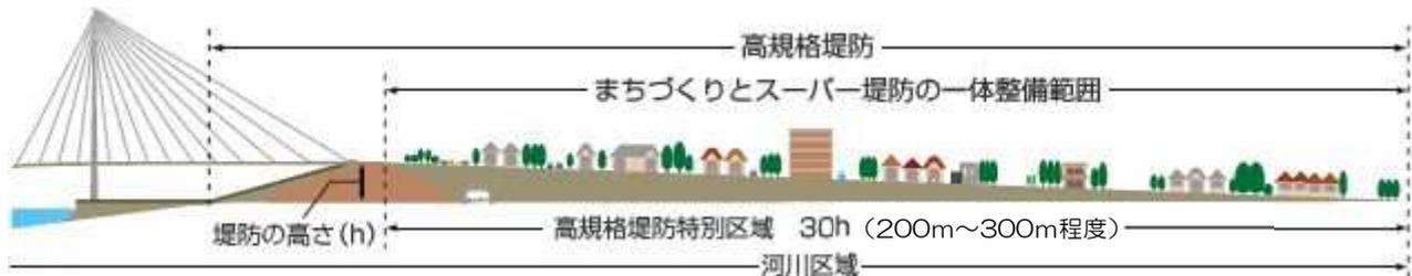
高規格堤防（スーパー堤防）断面図（イメージ）
