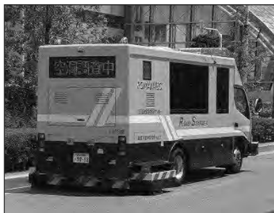
路面下空洞調査
