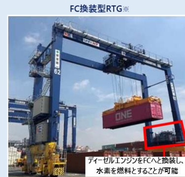
※ 国際海上コンテナを扱う荷役機械であるタイヤ式トランスファークレーン (Rubber Tired Gantry Crane) の略称
