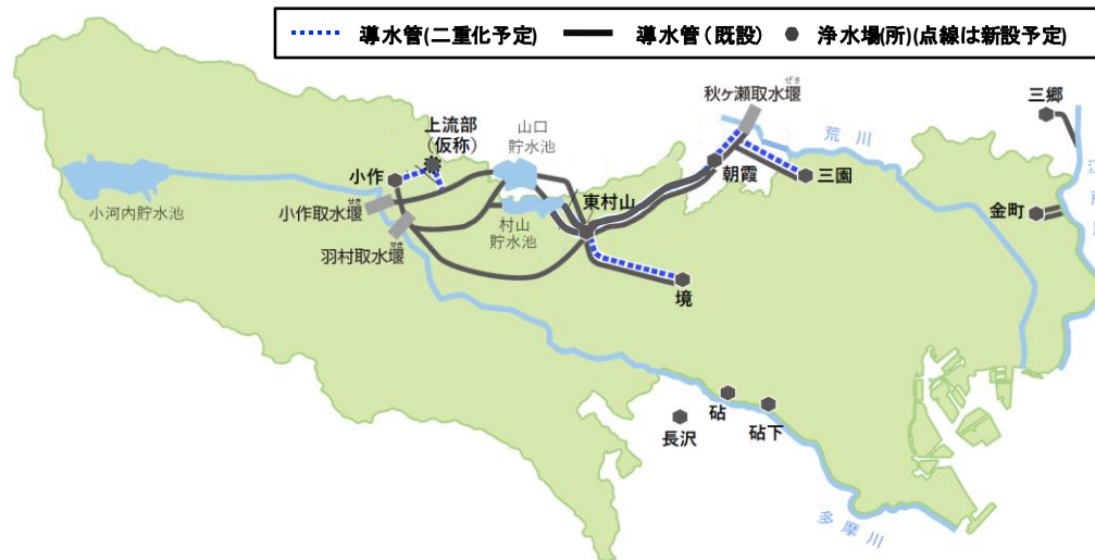
【導水施設の二重化の概略図】
