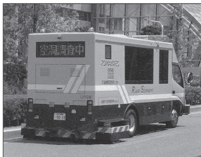
路面下空洞調査
