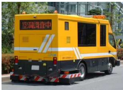
路面下空洞調査
