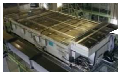
省エネルギー型汚泥濃縮機
