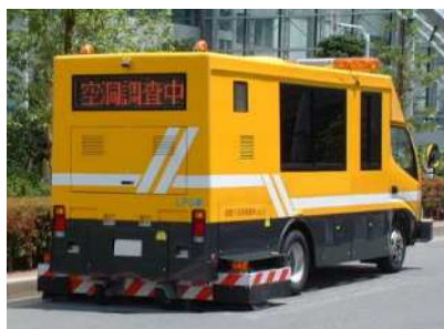
路面下空洞調査
