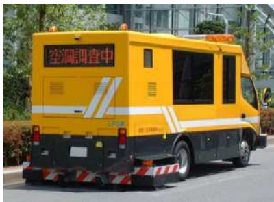
路面下空洞調査
