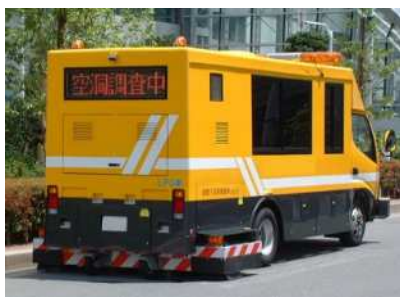
路面下空洞調査
