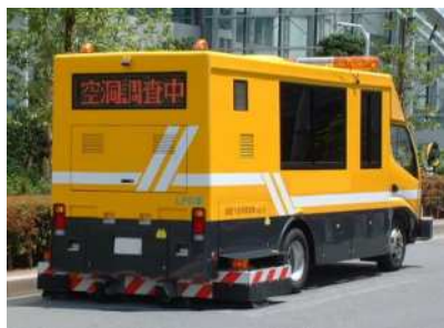
路面下空洞調査
